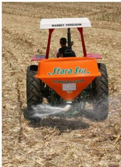
**Figura 6** - Sistema de distribuição centrífugo (um tubo)
